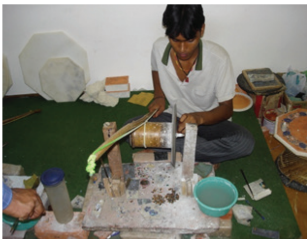
شکل شماره ۸ - انواع دستگاه های قدیمی و معمول تراش کابوشن
